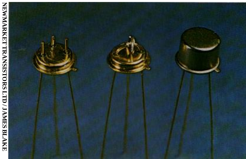
FIGURA 12: FASES DA CONSTRUÇÃO DE UM TRANSISTOR
