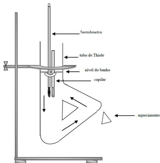
Determinação do ponto de fusão com tubo de Thiele
